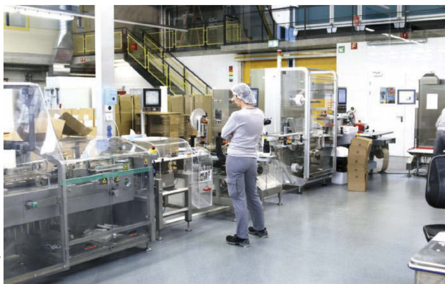
Die installierten Lösungen sorgen für mehr Flexibilität an der Linie. Im Bild v. li.: Kartonnierer, TQS-SP mit Tamper-Evident und TQS-CP.
